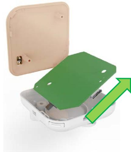
將電路板從開關方向，斜上方向，將卡榫卸下出電路板。
